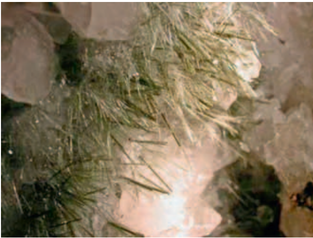
Fig. 6-4: Asbest (Amiant; Länge der einzelnen Nadeln bis etwa 100 µm).
