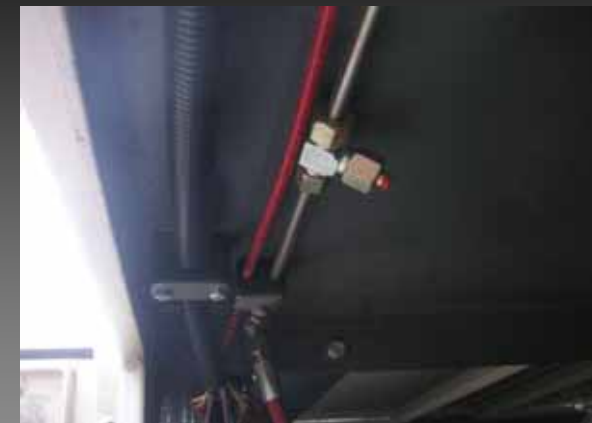
Detektionsschlauch und Löscheinrichtung mit Sprühdüse
