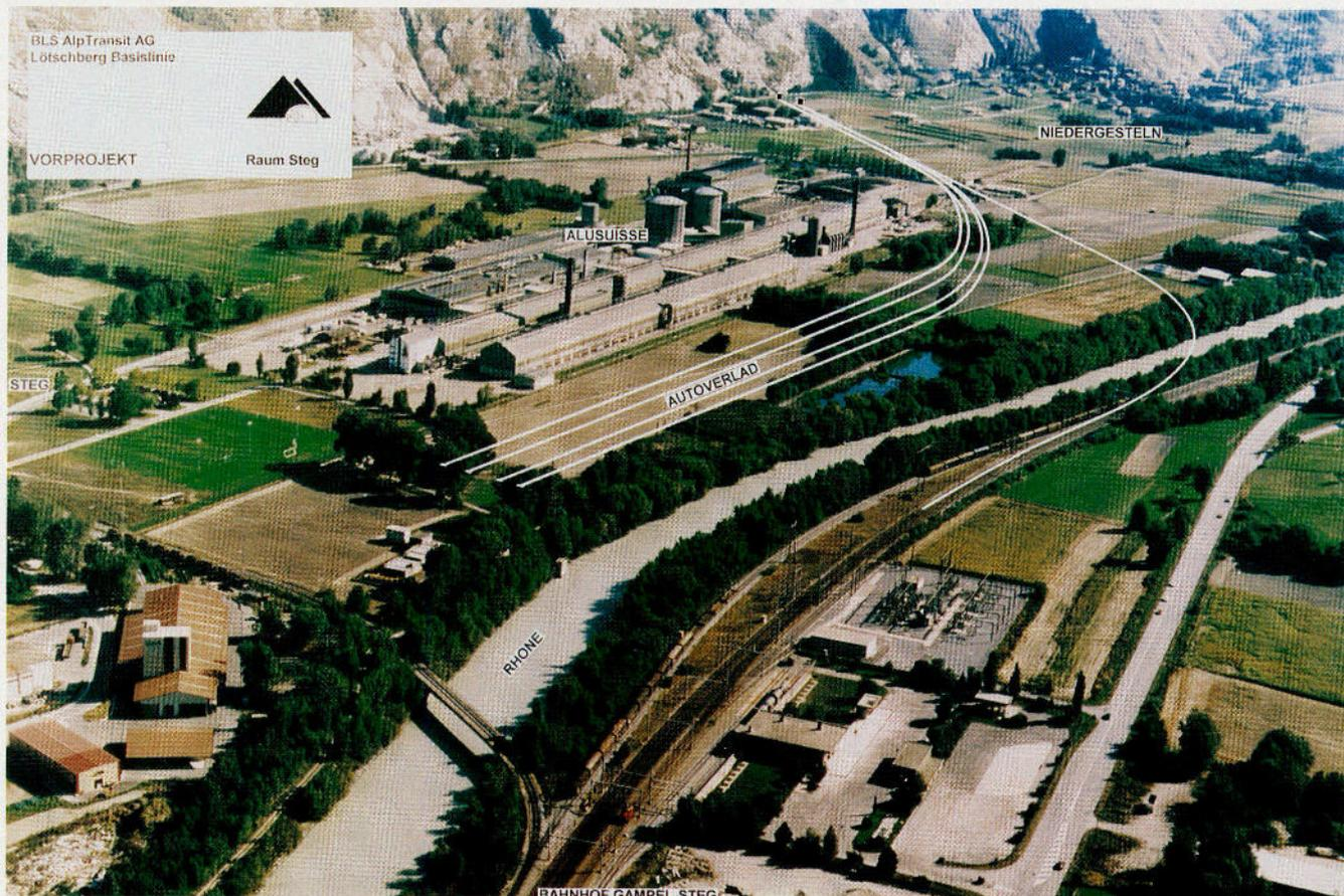
Anlagen im Raum Steg: Tunnelportal, Autoverladeanlage und direkte Verbindung Mittelwallis
