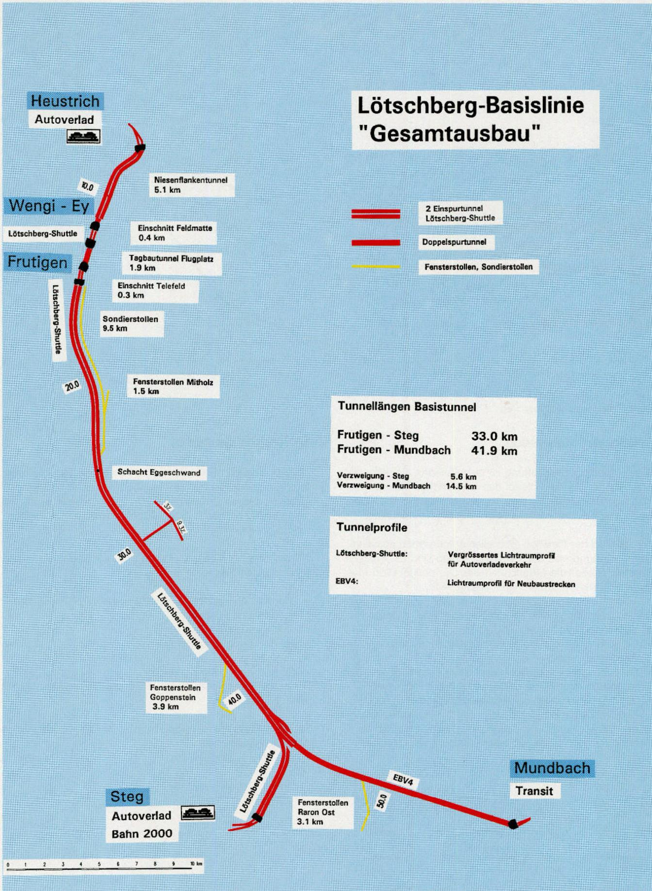
Charakteristische Elemente der Linienführung "Gesamtausbau"
