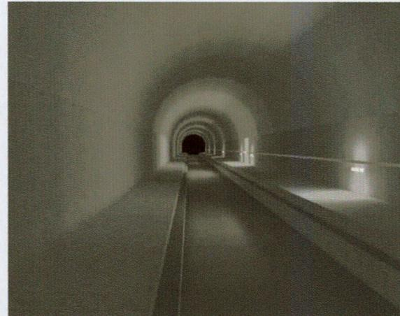
Abbildung 5: Darstellung aus dem Modell der Berechnung der Ausleuchtung [6] - links Querschlag, rechts Tunnelröhre
