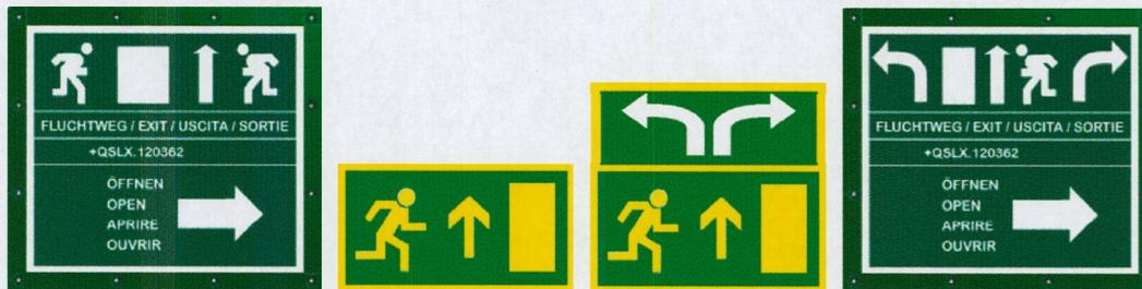
Abbildung 19: Mögliche Fluchtwegbeschilderung: auf QS-Türe in Bahntunnel (links), im Querschlag (mitte), sowie Beschilderung auf der QS-Türe im QS (rechts)
