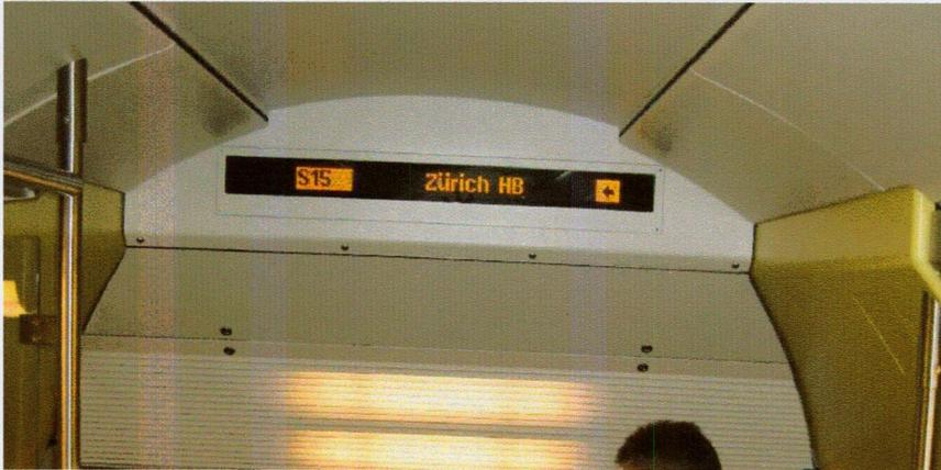
Abbildung 31: Wechseltextanzeige mit Anzeige der Ausstiegsseite beim Treppenabgang
