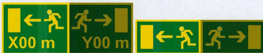
Abbildung 13: Mögliche aktive Beleuchtung des Fluchtwegschildes in Abhängigkeit vom Ereignistunnel in der NHS
