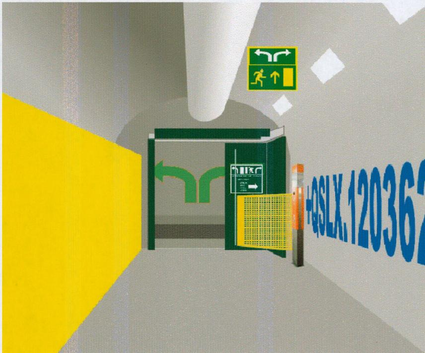
Abbildung 18: Mögliche Gestaltung beim Ausgang aus dem QS in den Bahntunnel
