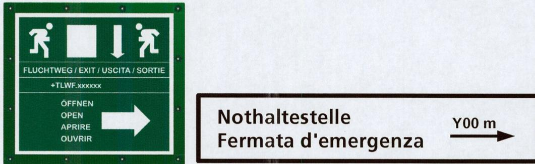
Abbildung 22: Mögliches Fluchtwegschild auf dem Spurwechsellort gestaltet nach [5] (links) und möglicher Fluchtplan (rechts) und mögliche Anschrift der NHS (rechts) an der Tunnelwand bei einer Distanz von weniger als 500 m zur NHS (Unabhängig von der Fluchtwegbeschilderung)
